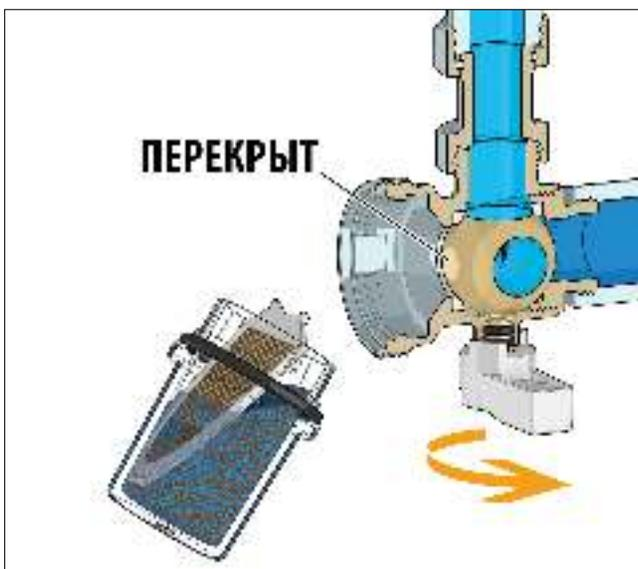
Особая конфигурация клапана-отсекателя позволяет осуществлять очистку внутренних элементов, сливая только то количество воды, которое содержится в фильтре.
